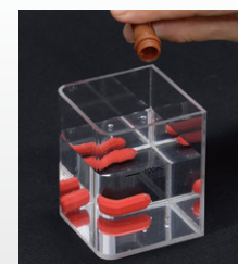
サンプリングしたバラスト水に染色剤を添加
